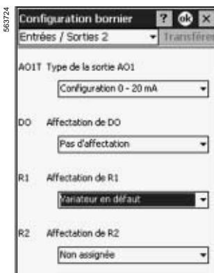
Configuration du relais de défaut avec PowerSuite pour Pocket PC
