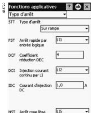
Configuration des types d'arrêt avec PowerSuite pour Pocket PC
