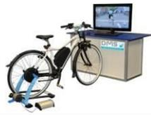
La deuxième chaîne part de la batterie qui fournit l'énergie au moteur via un convertisseur placé comme le moteur sur l'axe de la roue arrière (ce convertisseur d'énergie est aussi appelé variateur de vitesse électronique). Le moteur entraîne la roue arrière :
