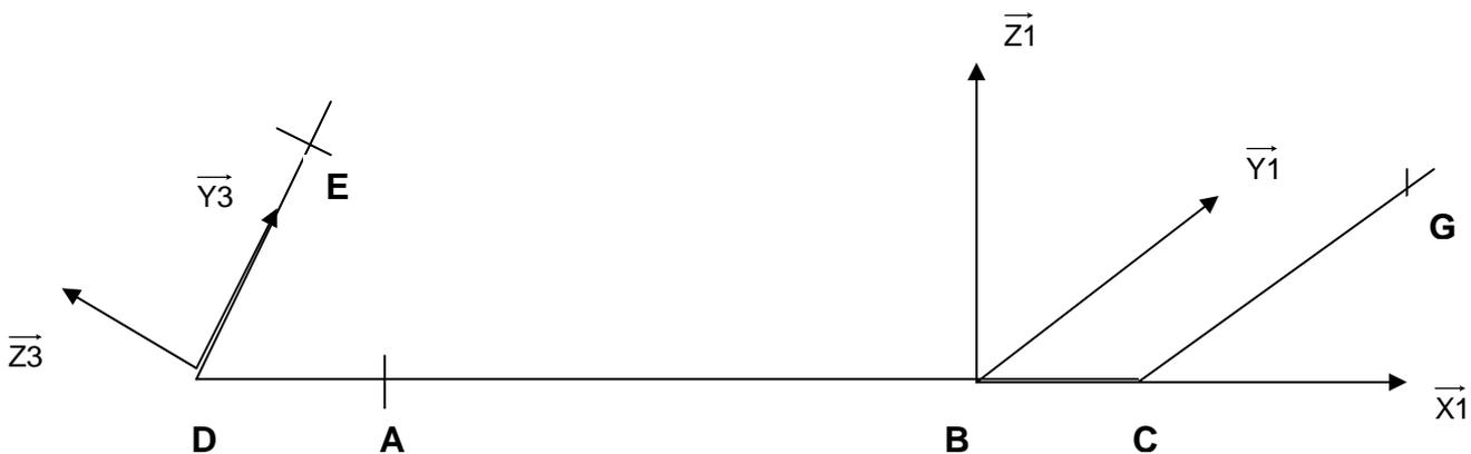
**2-5** : Remonter le palier Y à applique sans la plaque moteur et le bloquer sur la platine universelle. Faire de même avec l'autre palier mais sans serrer complètement les vis de fixation sur la platine universelle. Mesurer, par une méthode de votre choix, le débattement angulaire maximal (dans le plan horizontal) de l'axe de l'ensemble axe-lisse, qu'autorise le jeu de montage des vis de fixation du palier Y à semelle sur la platine universelle.
