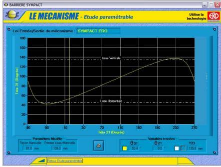
L'amplitude sans butée est de  $138^{\circ}$  -  $42^{\circ}$  =  $96^{\circ}$  > à  $90^{\circ}$  ; La limite d'amplitude étant de  $90^{\circ}$ , elle est obtenue au moyen de butées élastiques (caoutchouc).
