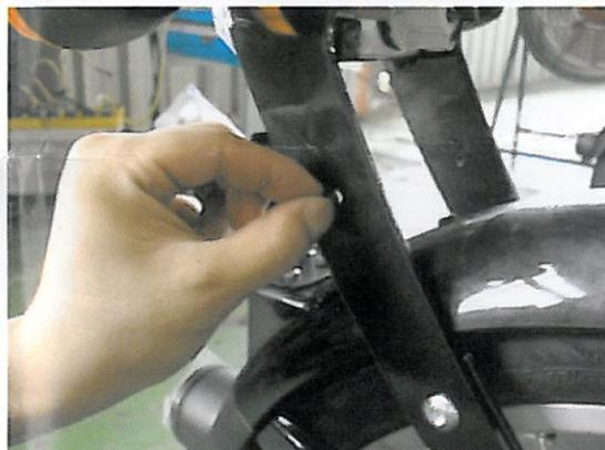
8) Retirer l'obturateur caoutchouc du trou taraudé
