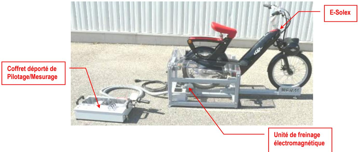
Le système est principalement constitué des sous-ensembles suivant :
