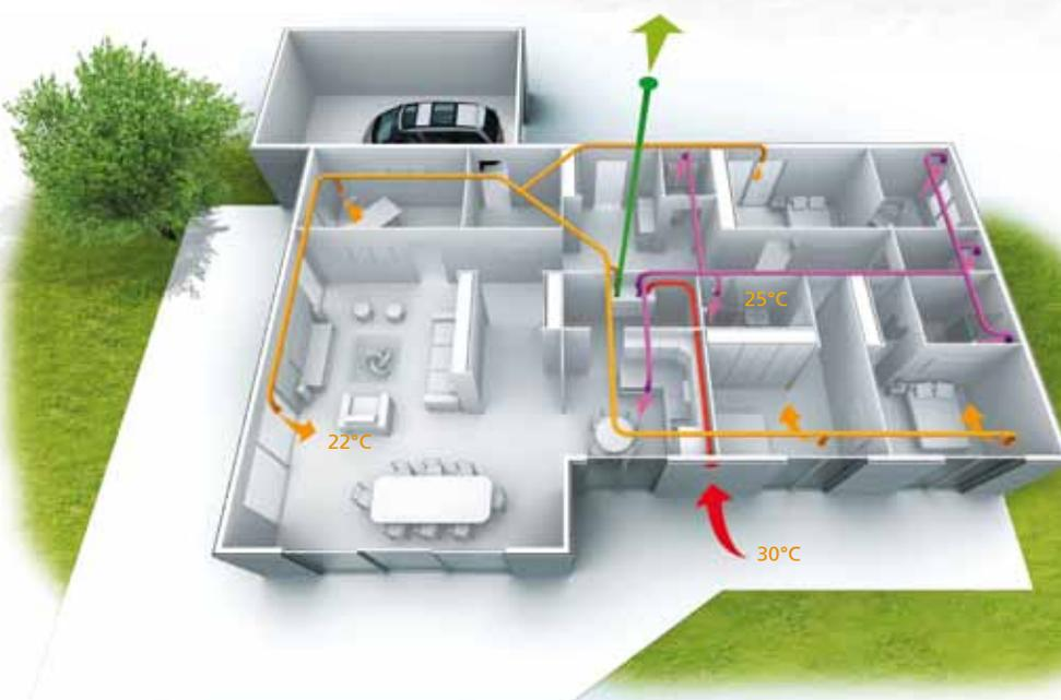
En **ÉTÉ**, l'air neuf se **refroidit** au contact de l'air extrait : il pénètre naturellement rafraîchi et évite de réchauffer votre logement.
