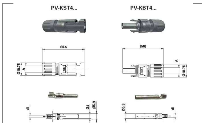
Figure 12. Détail de la nouvelle connectique MC
