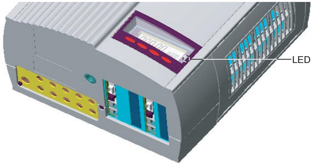
La LED change de couleur en fonction de l'état de fonctionnement de l'appareil.
