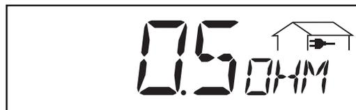
\*\* **Impédance du réseau ...** Résistance du réseau - critère pour une injection sûre dans le réseau (ohm ; option ENS)
