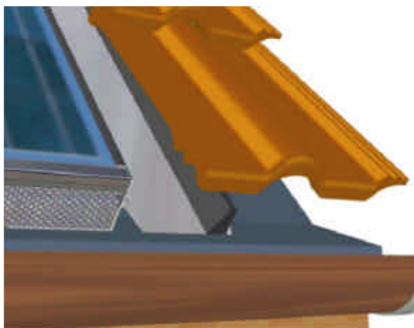
Figure 29. Etape 20 : pose des tuiles de rive
