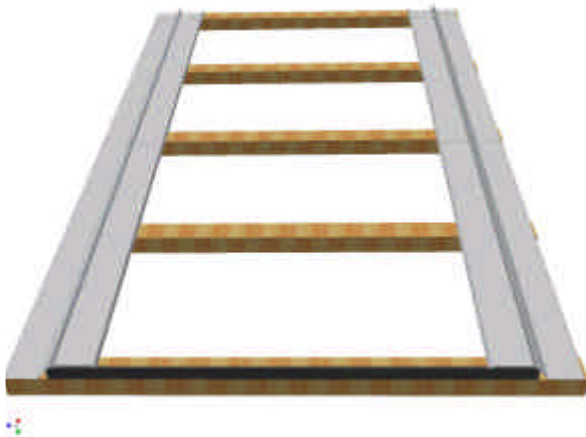
Figure 10. Etape 2 : positionnement de la pièce de ventilation basse
