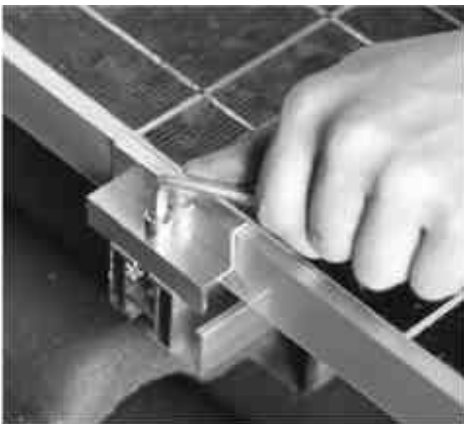
Figure 16. Fixation des 2 serreurs latéraux
