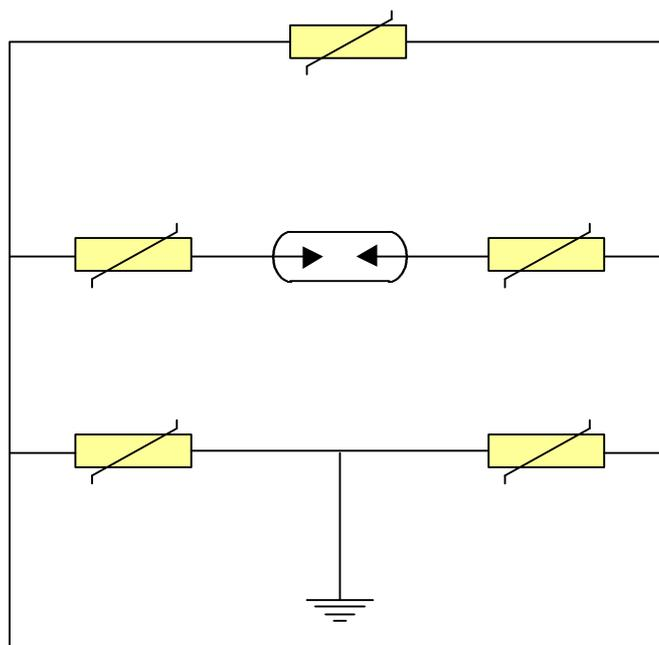
Un PSG tel qu'il est conçu chez Apex est composé de varistances et d'un éclateur à gaz, tels que présentés ci-dessus. Les varistances sont du type MOV de marque Siemens (SIOV).
