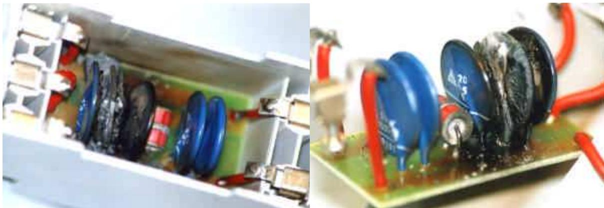
Lors des tests à l'ohmmètre, en prenant soin de ne pas détériorer davantage le PSG, il est apparu que la résistance était **finie** (une dizaine de mégohms) entre la polarité positive et le neutre, alors qu'elle restait infinie entre le plus et le moins. En revanche, en la 'deshabillant', on est effectivement en circuit ouvert entre le plus et le neutre (résistance infinie).
