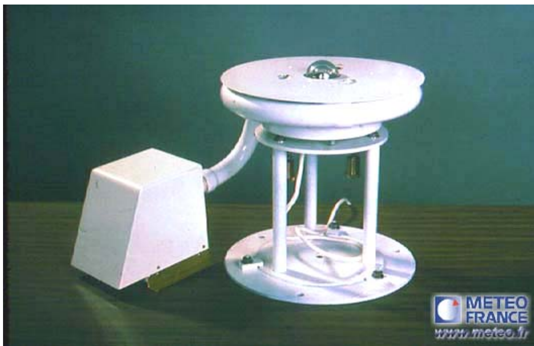
Le pyranomètre permet la mesure du rayonnement global et diffus. Ses applications sont l'hydrologie, l'agriculture, l'architecture, les travaux publics, l'étude des capteurs solaires.
