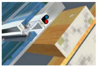
Intégration des câbles de raccordement dans le profilé de fixation des modules
