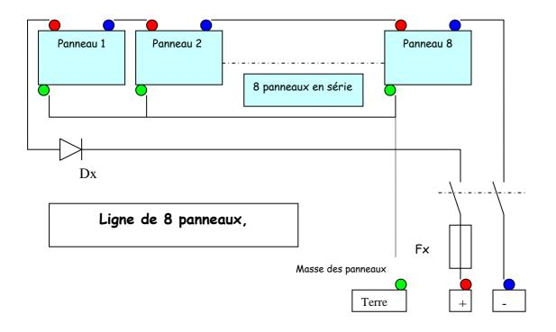
Schéma de principe de base pour une ligne de 8 panneaux
