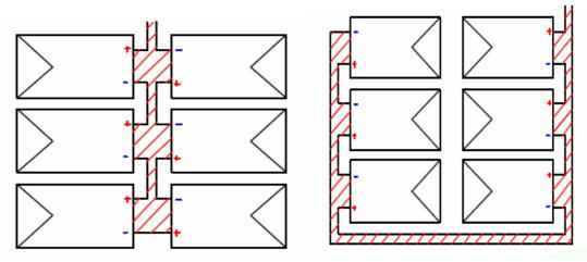
Exemples privilégiés pour le raccordement des panneaux au plan de la boucle (plan de masse) pour réduire les effets de la C.E.M.
