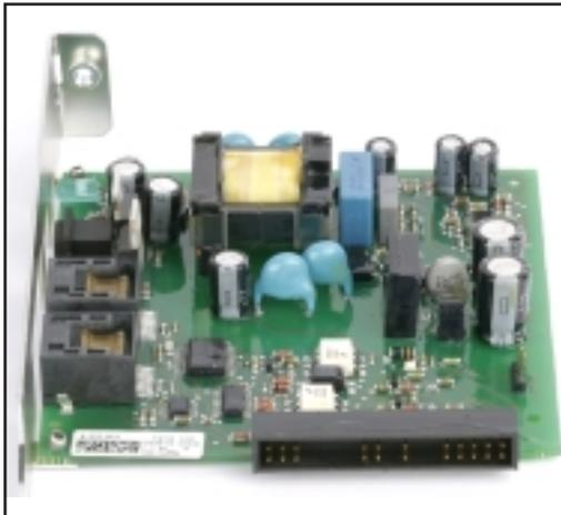
Las Com Cards permiten la conexión de datos del Fronius IG o del Fronius IG Plus a SolarNet y, de este modo, a los componentes DATCOM conectados. Por este motivo, las Com Cards sólo están disponibles en forma de tarjetas enchufables. Se requiere una Com Card por cada Fronius IG y por cada Fronius IG Plus.
