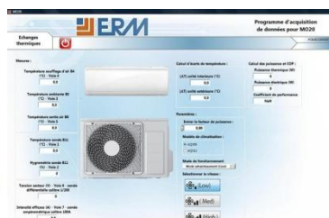
Mesures de températures puis calcul des puissances thermique, électrique et du COP.
