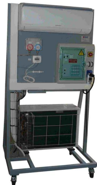
Mesures des températures en entrée et en sortie de chaque composants du circuit frigorifique
