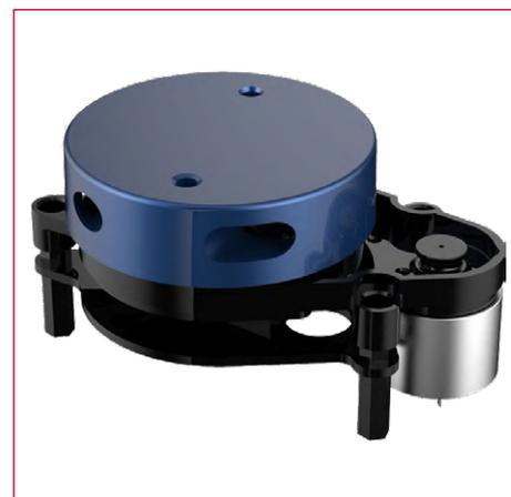
YDLIDAR X2 est un système Lidar de télémétrie à 360°. Cet instrument est basé sur le principe de la triangulation. Ses composants optiques et électroniques ainsi que ses algorithmes lui permettent de réaliser des mesures de distance avec une grande précision. La mesure de distance est complétée par des informations sur le balayage à 360° puisque l'angle de rotation est continuellement indiqué
