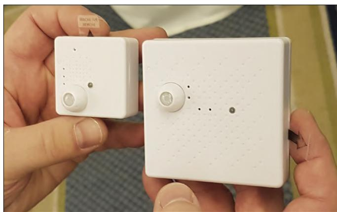
Figure 2. Deux variantes du même nœud de capteurs, l'une avec LoRa, l'autre avec NB-IoT ([www.tektelic.com](http://www.tektelic.com)).
