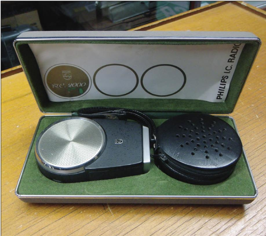
Figure 6. Le récepteur pour ondes moyennes Philips IC2000 de 1967, et son étui. Ce que l'on voit à droite est le chargeur avec adaptateur secteur.
