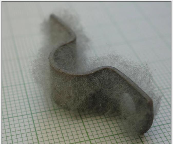
Figure 8. Formation de filaments sur un étrier en acier galvanisé (source : Wikipédia).
