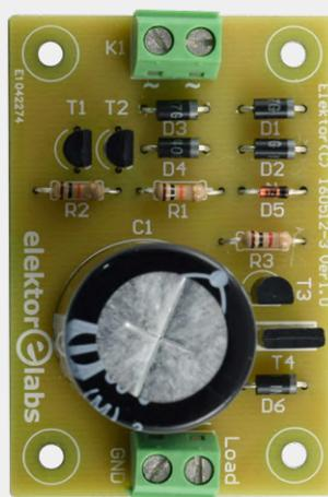
avec une spécification de 1 W. Montez ces résistances légèrement au-dessus du circuit imprimé. La dissipation sera la plus grande sans charge.
