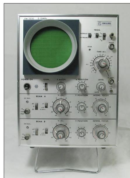
Figure 5. L'oscilloscope Philips PM3230, qui fonctionne avec des tubes, des diodes au silicium, et des transistors au germanium et au silicium. Photo : Gerrit Busscher.
