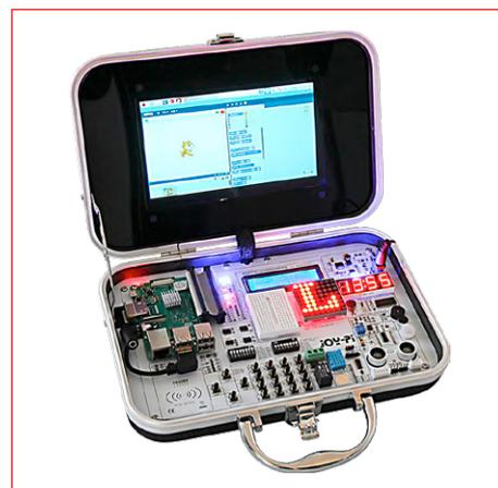
Le JoyPi est un boîtier d'expérimentation animé par un Raspberry Pi. Il est idéal pour s'initier à l'électronique et la programmation. Le système de boîtier offre un environnement tout-en-un parfait, qui permet d'éviter la pagaille des composants et des câbles éparpillés sur la pailasse. Le JoyPi dispose d'un grand nombre de capteurs et de modules accessibles aux débutants.
