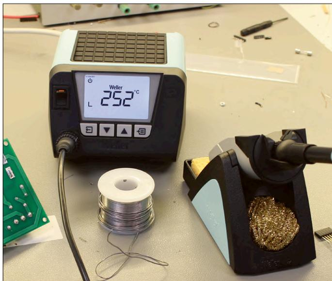
Outre le connecteur du fer à souder en face avant, l'appareil comporte, à proximité de la base, une prise jack de 3,5 mm pour égaliser les potentiels (fiche de réserve livrée), ainsi qu'une prise RJ11 pour le système d'extraction Zero Smog de Weller. Le cordon d'alimentation secteur se branche à l'arrière.
