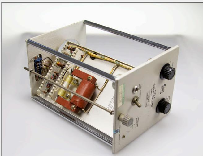
vient d'un interrupteur à mercure ouvert et fermé par un transformateur. Le type P ne désigne pas un instrument à part entière, mais un module additionnel pour les séries Tek 53x/54x/55x uniquement.
