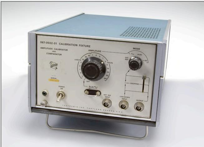
**Description :** générateur d'onde carrée à 1 kHz avec sortie précise en fréquence et amplitude. Plage de sortie de  $200\text{ mV}_{cc}$  à  $100\text{ V}_{cc}$  sur charge de  $1\text{ M}\Omega$  en 18 bandes. Boîtier Tektronix standard de  $35 \times 23 \times 14\text{ cm}$ .
