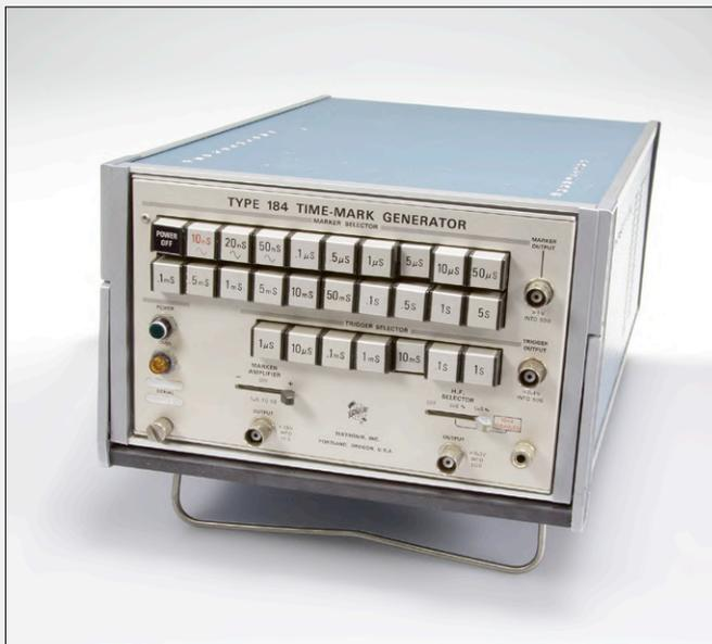
**Description :** offre un choix de 16 repères temporels et 5 intervalles de marques de sinus, pour une plage totale allant de 2 ns à 5 s. Impulsions de déclenchement pour l'appareil à tester entre 1  $\mu$ s et 5 s. La précision du 184 est due à un quartz à 10 MHz confiné dans un four à température contrôlée. Boîtier Tek standard de 35 x 23 x 14 cm.
