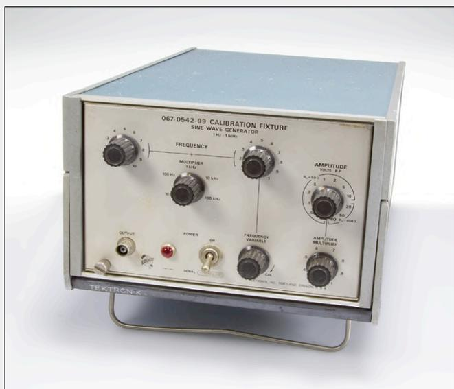
**Description :** générateur sinus de  $10\text{ Hz}$  à  $1\text{ MHz}$  par paliers, précis en fréquence et en tension. Sortie entre  $20\text{ mV}_{cc}$  et  $100\text{ V}_{cc}$  sur charge de  $50\ \Omega$  ( $20\text{ V}$ ,  $50\text{ V}$ ,  $100\text{ V}$  sur  $450\ \Omega$ ), en 12 gammes. Fréquence ajustable par pas et à variation continue. Boîtier standard Tek :  $35 \times 23 \times 14\text{ cm}$ .
