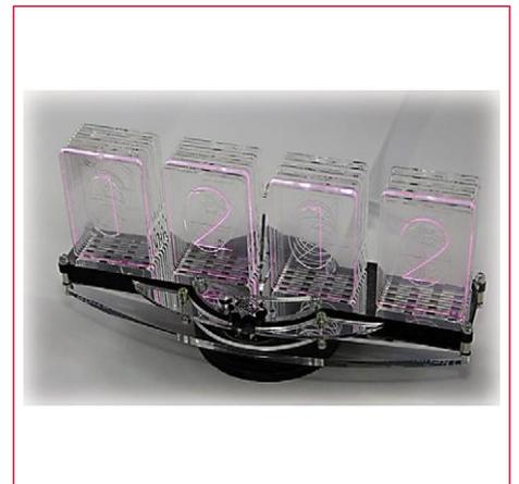
L'horloge NixieCron M4 comprend une puce de montre de haute précision, compensée en température avec une dérive de seulement quelques secondes par mois. Elle est livrée avec un module de son, qui sonne les heures et annonce l'heure actuelle sur simple pression d'un bouton. Il est également possible de connecter un capteur de température DS18B20 et de le configurer à l'aide d'un bouton rotatif.
