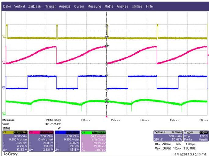
Figure 7. Signaux du circuit antirésonance pour un angle de pas de 15° et 901,75 Hz. C1 : impulsions de 30 μs sur SJ4 ; C2 : dents de scie sur SJ1 ; C3 : signal MLI sur SJ2 ; C4 : signal du shunt,  $U = f(IT)$  sur X2-6.
