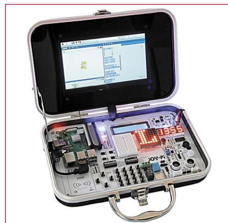
Le JoyPi est un boîtier d'expérimentation animé par un Raspberry Pi. Il est idéal pour s'initier à l'électronique et la programmation. Le système de boîtier offre un environnement tout-en-un parfait, qui permet d'éviter la pagaille des composants et des câbles éparpillés sur la paillasse. Le JoyPi dispose d'un grand nombre de capteurs et de modules accessibles aux débutants.
