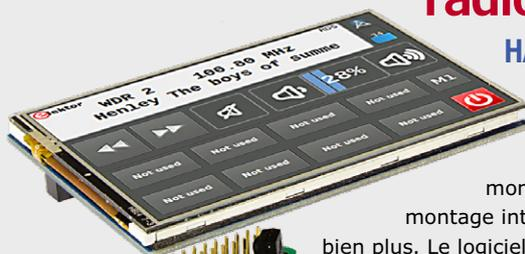
Construire une radio FM avec un nano-ordinateur Raspberry Pi et un tricorne fait maison monté en impériale (HAT), voilà un montage intéressant. Toutefois ce projet offre bien plus. Le logiciel (pilotes et interface graphique écrits spécialement pour cette application) ainsi que le matériel constituent un formidable terrain d'expérimentation assorti d'une documentation fouillée.
