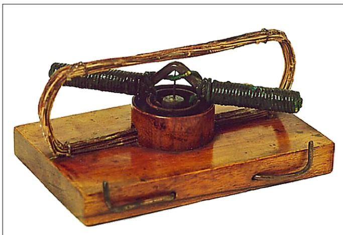
Figure 1. Moteur Jedlik de 1827 (illustration : Wikimedia Commons [2]).
