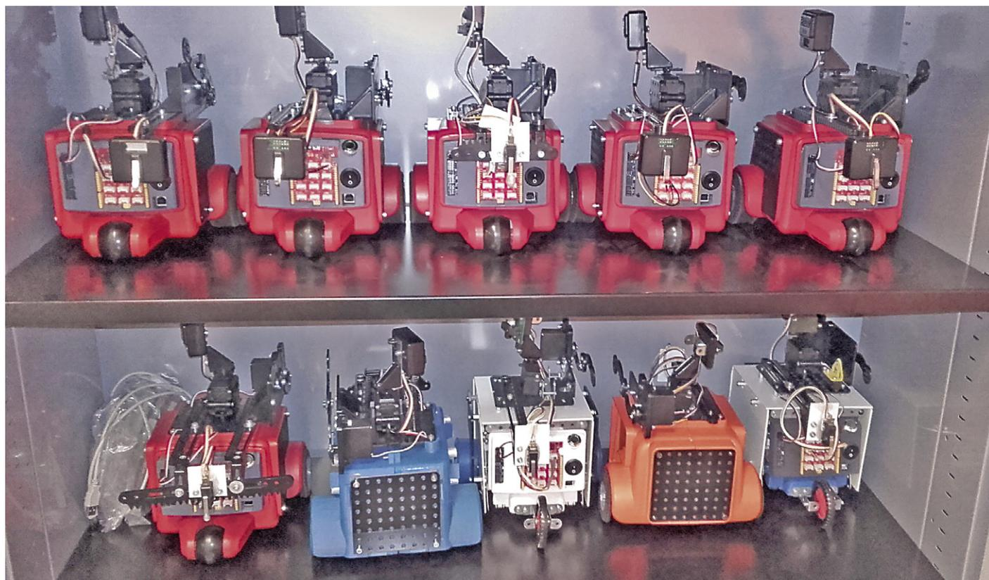
Vous recherchez un robot programmable et modulaire pour travailler avec vos élèves ? Construisez un ou plusieurs robots avec la carte PobDuino. Grâce à elle, vos robots seront pétris de qualités : ils seront programmables en Flowcode (la licence de base suffit) et pourront utiliser des cartes compatibles Arduino pour le branchement de capteurs et d'actionneurs.
