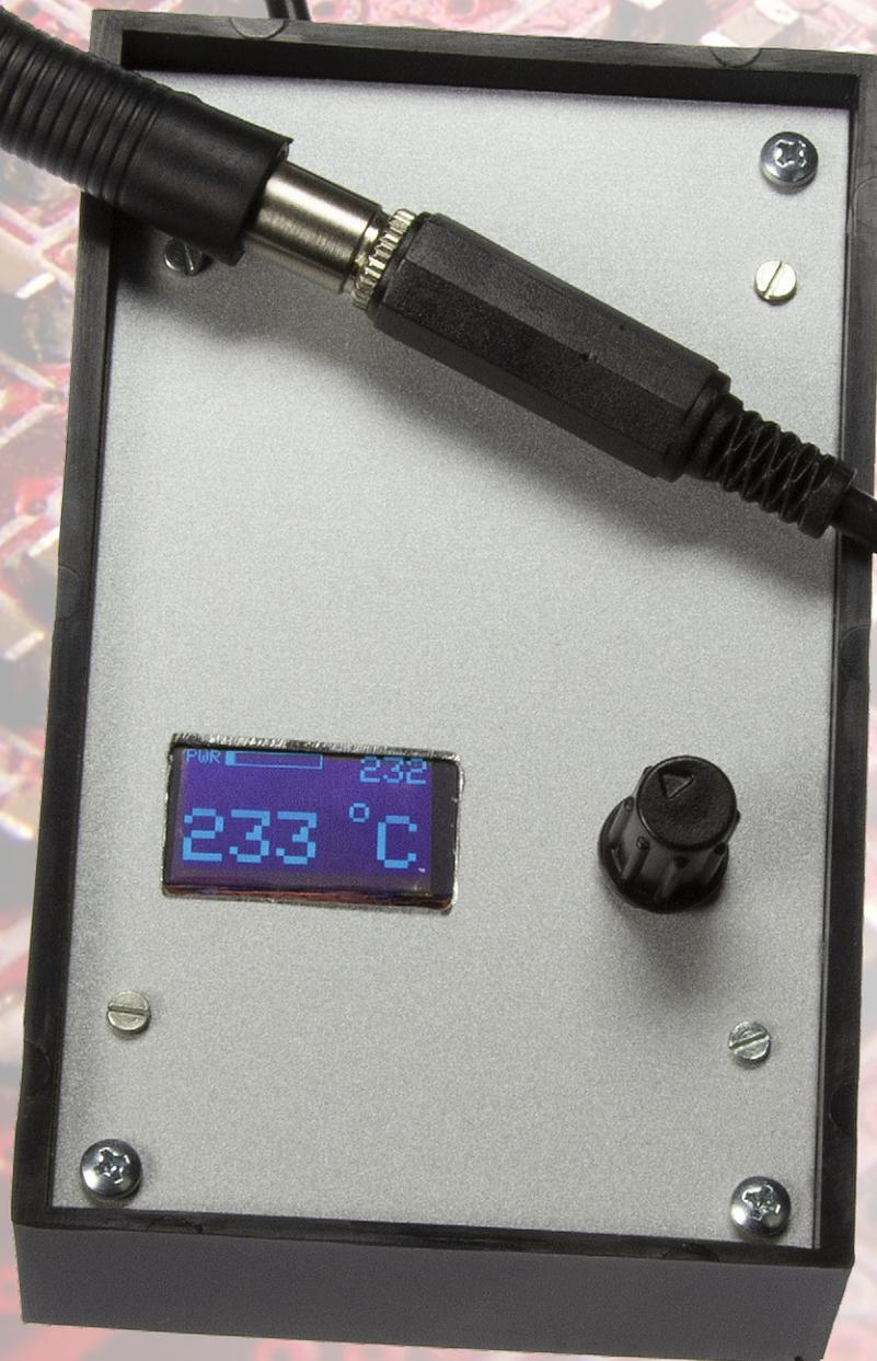
Le poste de soudage de CMS à construire soi-même de juillet/août 2015 [1] utilisait les têtes de soudage de la série RT de Weller et leur bien pratique jack stéréo de 3,5 mm. Ce nouveau projet repose également sur les têtes avec élément de chauffe et capteur de température intégrés. Il reste à fournir assez d'énergie pour chauffer la pointe et à réguler avec précision sa température.
