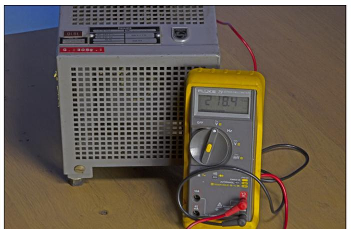
Figure 4. Délaissé pendant plus de 30 ans, le PE1033 n'a rien perdu de sa stabilité : la tension de sortie reste toujours dans la fourchette spécifiée de 1 % autour de 220 V~. Tension d'entrée : 232 V~.
