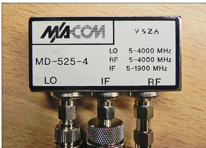
Figure 6. Pour mes expériences, j'ai utilisé ce mélangeur MACOM. Il est spécifié jusqu'à 4 GHz.
