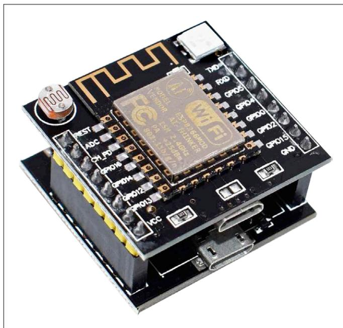
Figure 1. La carte de développement Wi-Fi Witty Cloud, très bon marché, est constituée d'un empilement de deux circuits imprimés. La partie inférieure est le programmeur.
