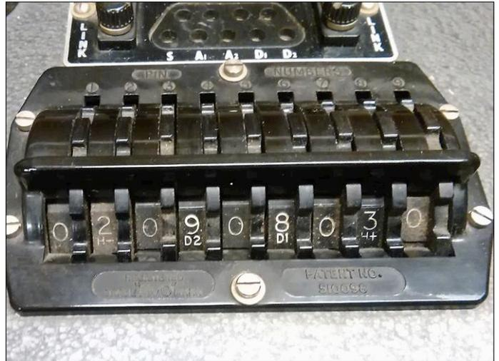
Figure 4. Le carrousel de commutateurs à molette. Chaque tube a son code unique. Photo : Gerrit Busscher.
