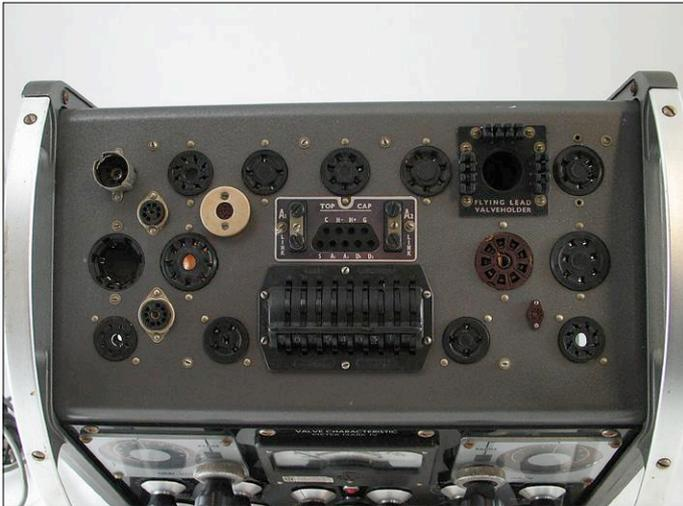
Figure 3. Des supports adéquats à tous les tubes en usage. Photo : Gerrit Busscher.
