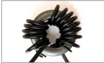
Figure 6. Du câble coaxial bobiné sur un noyau de ferrite.
