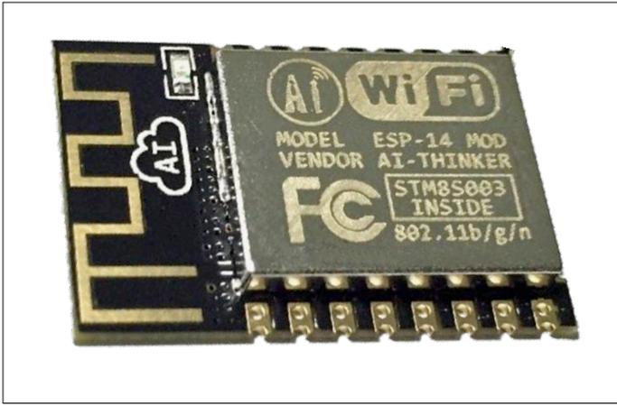
Figure 3. Le module ESP8266 de type ESP-14 ne contient pratiquement tout le nécessaire pour une télécommande Wi-Fi, y compris une antenne imprimée.
