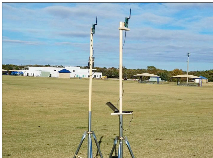
Figure 2. Système de collecte des données pour le calibrage des courtes distances (0,6 à 300 m).
