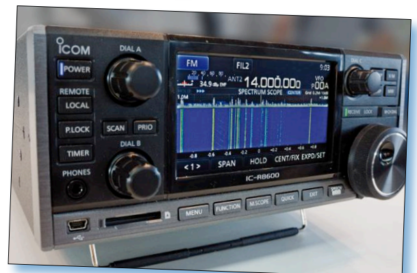
Photo 7. Récepteur ICOM SDR IC-8600 de 10 kHz à 3 GHz.
