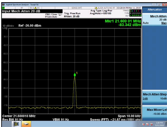
Figure 9. Par rapport à la figure 8, mesuré avec une atténuation de 26 dB, le niveau a été réduit à 89 dBc.
