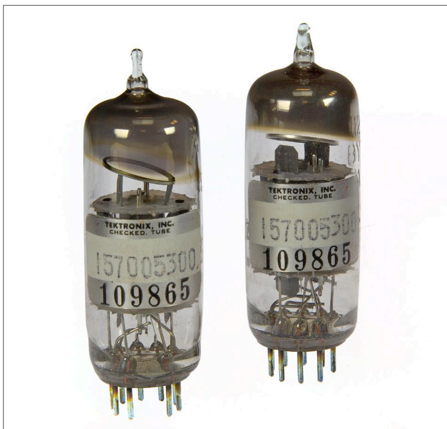
Figure 8. Tektronix n'achetait pas les onéreux tubes SQ, mais sélectionnait les meilleurs exemplaires dans de grosses quantités de production ordinaire en les testant principalement sur leur pente et la microphonie. Ici un duo de 12BY7A emprunté à un vieil oscilloscope.
