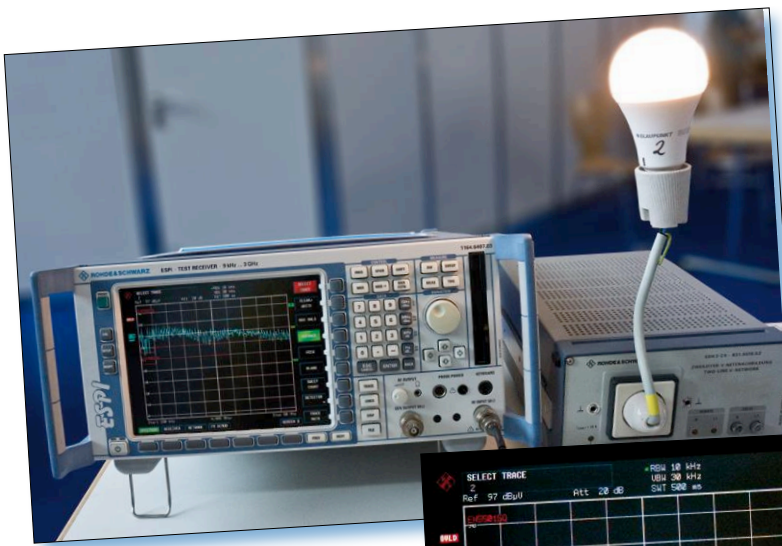
Photo 8. Dispositif de mesure des émissions parasites des lampes LED du stand du service CEM du DARC.
