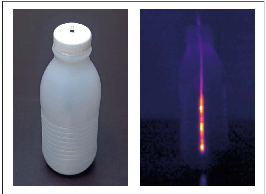
Figure 5. Une bouteille de lait en polyéthylène laisse passer les rayons IR.
