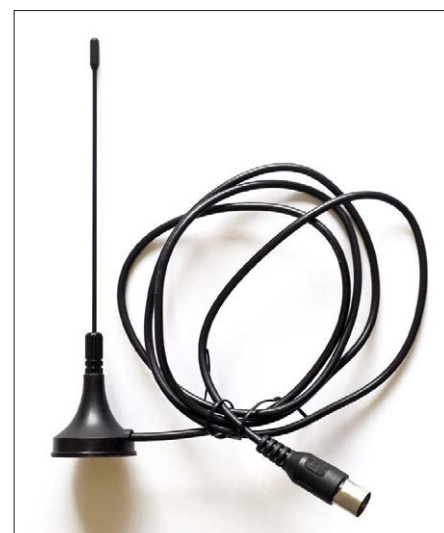
Figure 3. L'antenne stub à support aimanté de la clé blanche moins onéreuse.
