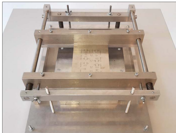
Figure 4. La barre avant est tirée vers la contre-barre au moyen d'écrous papillon.
