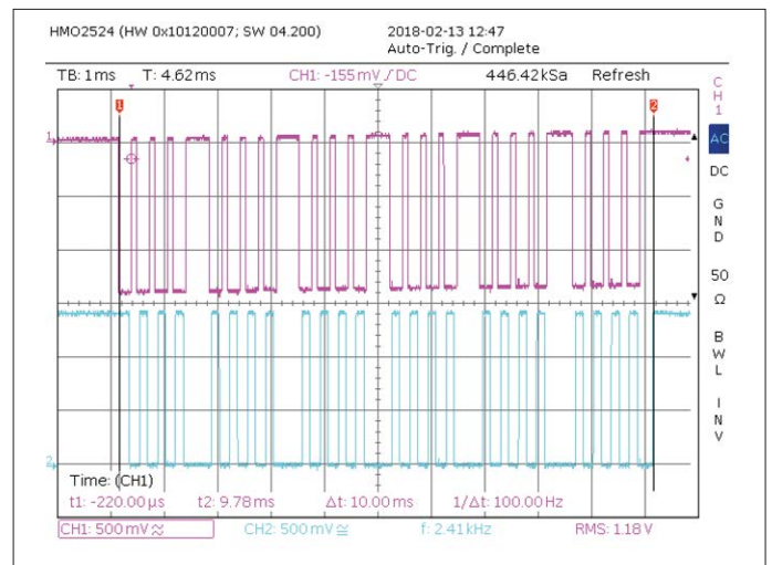
Figure 3. Le protocole de données (en haut, en magenta) doit être décodé (ici la règle de mesure est mise à 0,00). Le signal d'horloge (en bas, en cyan) est actif à l'état bas et s'interrompt brièvement après quatre fronts.
