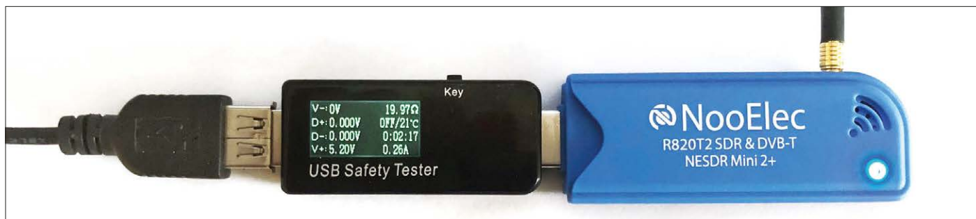
Figure 7. La consommation de courant de la clé bleue utilisée comme radio DAB.
