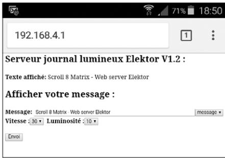
Figure 4. Page web de configuration de l'afficheur.
