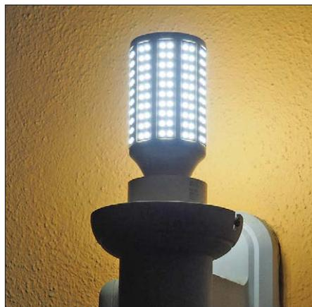
Figure 2. Lampe à LED plus âgée, à culot E27 et tapissée d'une foule de LED CMS. À ne pas toucher à mains nues quand elle est allumée !
