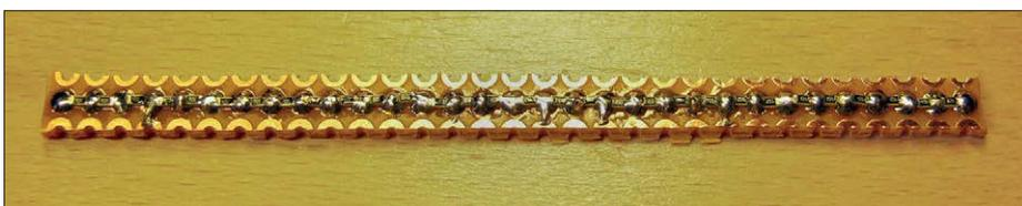
Figure 10. Diviseur de tension par  $30 \times 10 \text{ M}\Omega$  avec la résistance de mesure de  $100 \text{ k}\Omega$  astucieusement au milieu.
