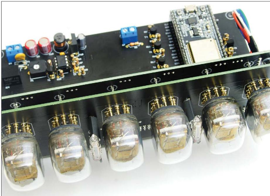
Figure 10. L'horloge complètement montée, mais pas encore incorporée au boîtier. Remarquez le placement des deux tubes DM160.
