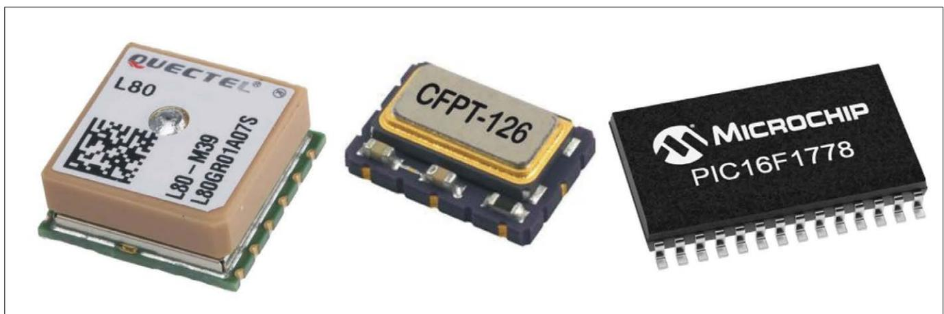
Figure 2. Si on fait abstraction de quelques « accessoires », trois composants suffisent pour l'étalon de fréquence.
