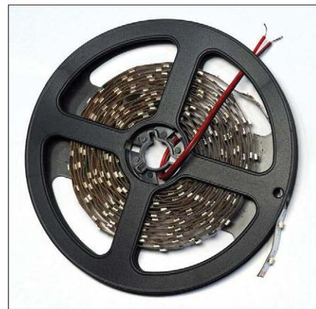
Figure 3. Ruban de 4 m, équipé de LED CMS au format 3528.
