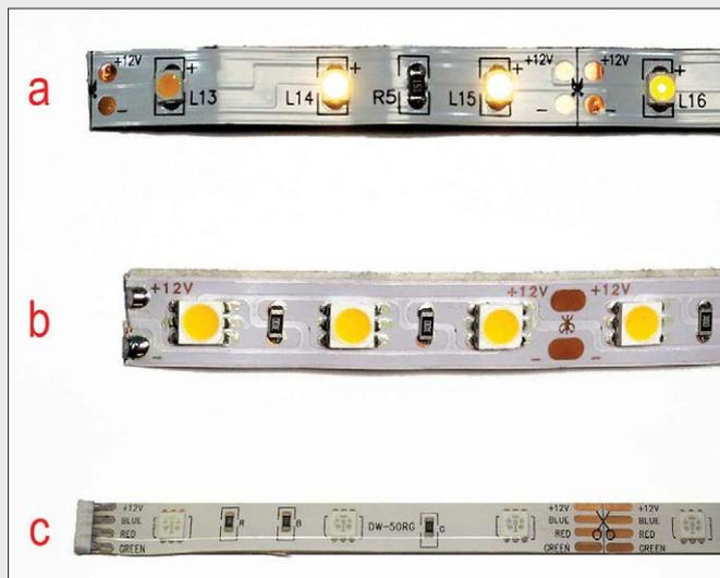
Figure 9. Vues de près de modèles de rubans à LED dans le même ordre que sur la figure 4 : 9a = blanc chaud 3528, 9b = blanc chaud 5050 et 9c = RVB 5050.
