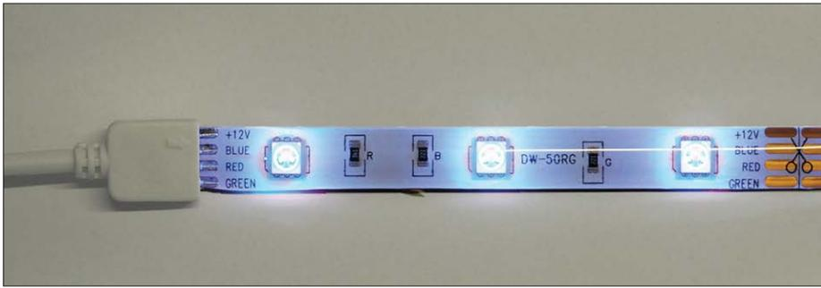
Figure 10. Un fragment de ruban RVB réglé sur « blanc » avec l'éclairage le plus faible. Le blanc tire visiblement sur le bleu, soit une très haute température de couleur.
