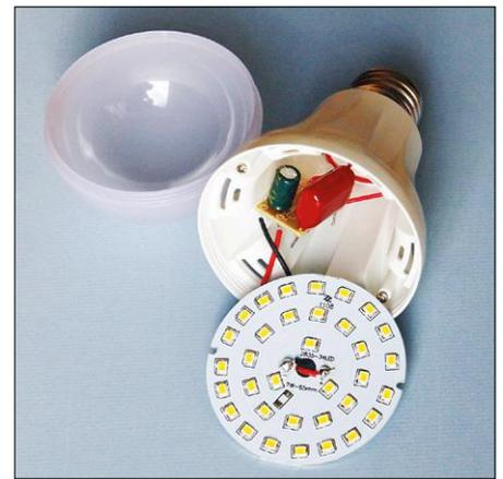
Fig. 1. Entrailles d'une lampe à LED bon marché : condensateur série, diode, condensateur de filtrage et résistance de décharge. L'inscription le montre : seulement 7 W au lieu des 10 W indiqués.
