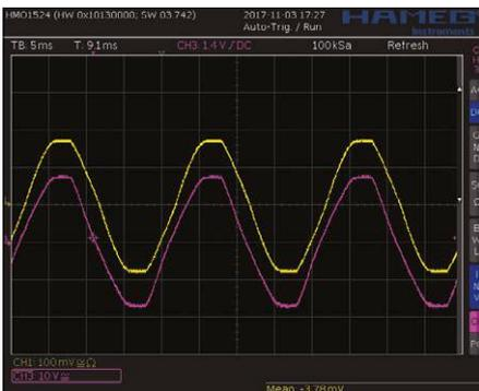
Fig. 3. Courbes de tension et de courant de la lampe à incandescence.
