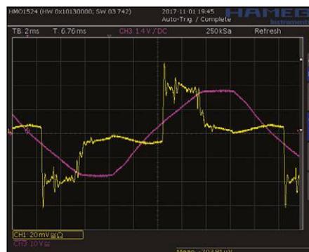
Fig. 7. Courbes de tension et de courant de la lampe 4.
