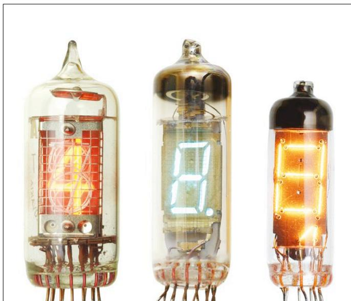
Figure 2. De gauche à droite : un tube Nixie, un VFD et un Numitron.
