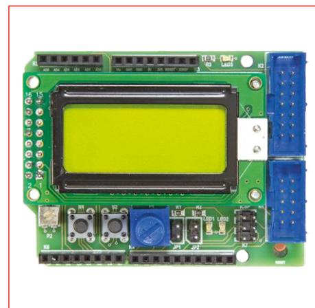
Le *shield* proposé en 2014 améliorait la carte Arduino avec des LED, des boutons-poussoirs, un écran LCD et un accès à l'interface UART et aux broches du microcontrôleur. Ce *shield* a suscité – et suscite encore – beaucoup d'intérêt ; une révision s'imposait donc ! La version 2.0 de ce *shield* permet maintenant de connecter n'importe quel écran LCD standard avec connexion à 2x8 trous.
