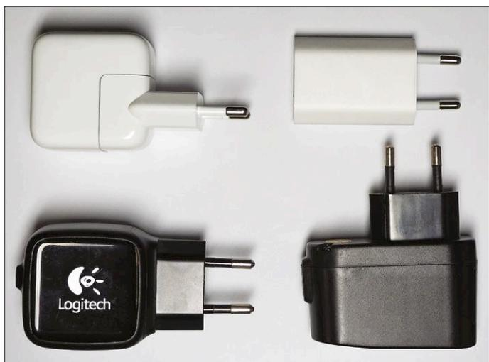
Figure 1. Divers chargeurs USB. De gauche à droite : chargeur Apple 10 W pour iPad, chargeur Apple 5 W pour iPhone, chargeur Logitech 5 W, chargeur Noname 5 W.
