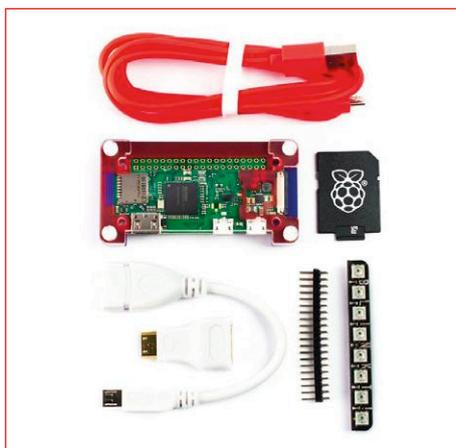
Un kit avec tout ce qu'il faut pour démarrer avec le nouveau Raspberry Pi Zero W ! Il comprend une bande de huit LED multicolores *Blink!*, un boîtier acrylique, une carte micro-SD de 8 Go avec NOOBS 2.2 préchargé, un connecteur mâle à 2x20 broches, 2 câbles USB, un adaptateur HDMI et bien sûr un Raspberry Pi Zero W avec puce monocœur, Wi-Fi et Bluetooth intégrés. Parfait pour effectuer vos premiers pas en Python.
