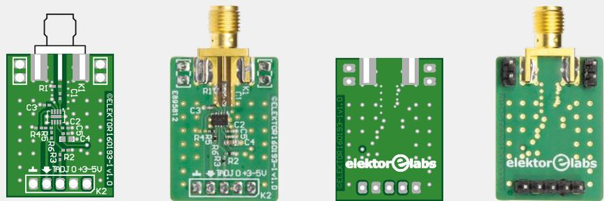
Figure 4. Pas moins de quatre couches pour le circuit imprimé du module RF !
