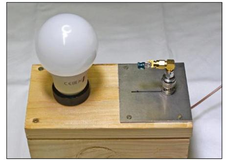
Fig. 22. Une petite bobine comme sonde magnétique à 5 cm de distance de la lampe.
