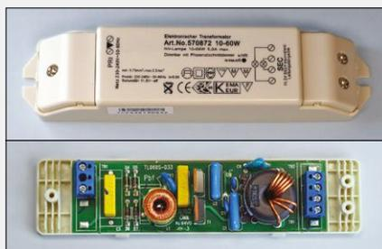
Fig. 32. Transformateur électronique et son intérieur spartiate.
