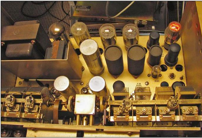
Figure 2. Vue plongeante dans l'oscillateur dans l'état d'origine. En haut à gauche, le transformateur de puissance, malheureusement défectueux dans mon appareil. À droite, la self de choc de 6 H (oui, henry). Les six tubes de la rangée arrière font tous partie de la stabilisation de l'alimentation. NB : cette photo a été prise bien avant qu'il ne fût question d'un article dans Elektor !
