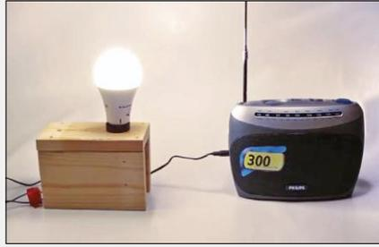
Fig. 31. Test de CEM avec un récepteur radio FM.
