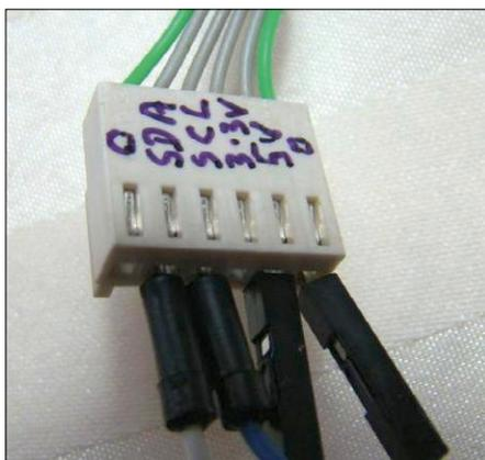
Figure 2. Un étiquetage clair des connecteurs permet d'éviter les erreurs de câblage.
