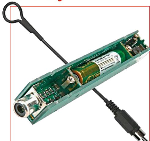
Ce détecteur de pollution électromagnétique à large bande et ultra-sensible permet de détecter toute source de champ électrique E ou magnétique H, normalement inaudible. Le TAPIR, acronyme de *Totally Archaic but Practical Interceptor of Radiation* est ultra simple à utiliser. Branchez les écouteurs et une antenne, allumez-le. Approchez-vous d'appareils électriques et vous entendrez différents bruits (suivant le type et la fréquence du champ émis).
