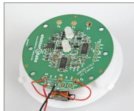
Figure 5. Le circuit de la bio-lampe monté sur le support de piles. Notez comment l'interrupteur est connecté entre les trous H1 et H6.
