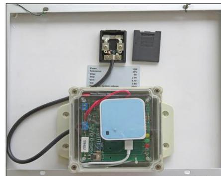
Fig. 3. Montage de l'ensemble au dos du panneau solaire.
