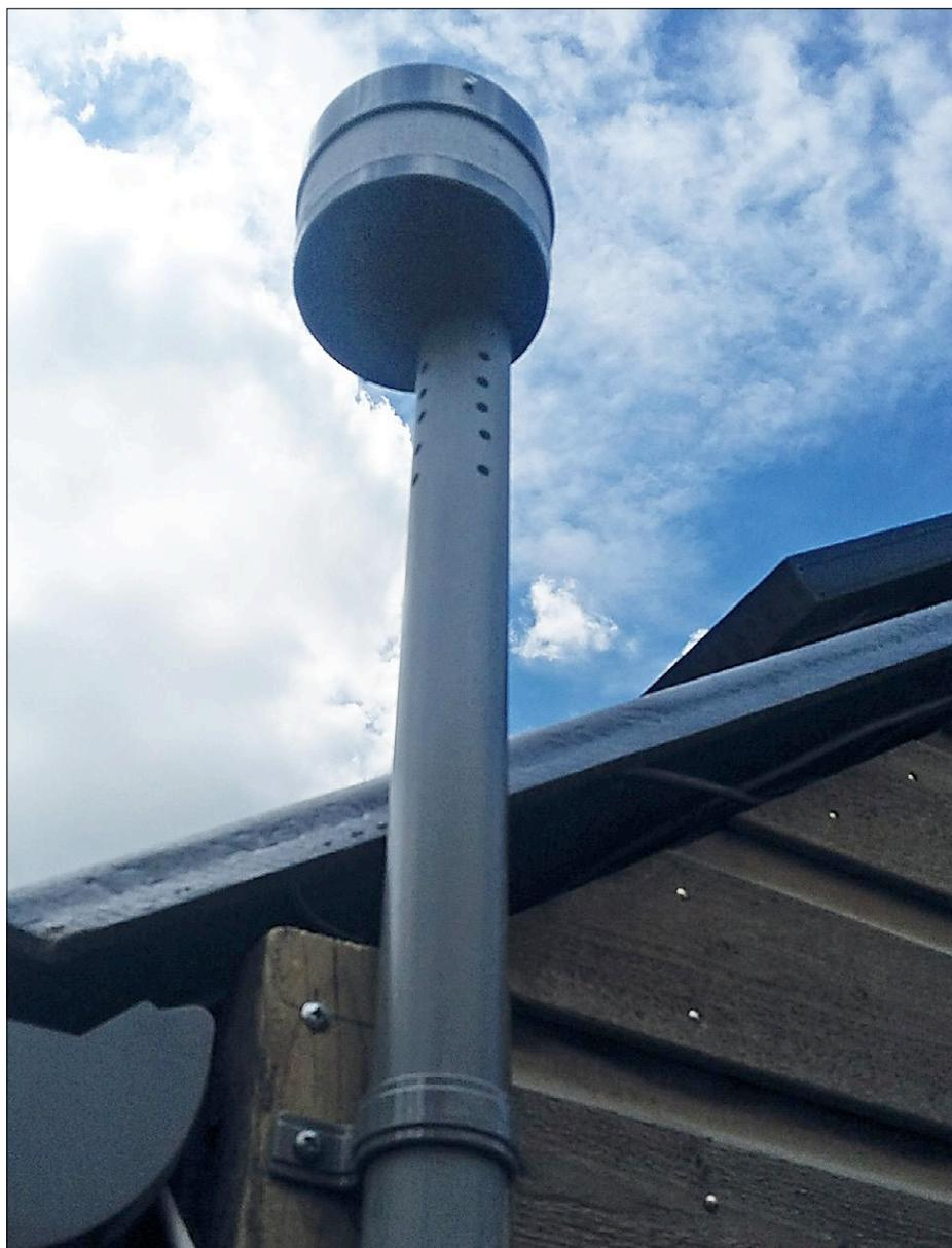
Figure 9. Le capteur éolien dans son élément, au-dessus du toit.
