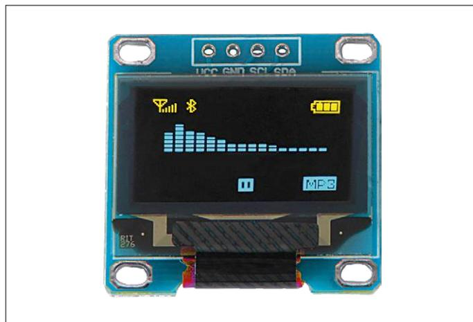
Figure 5. Écran OLED bicolore avec contenu de démonstration.
