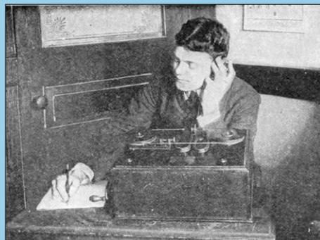
Un opérateur radio reçoit un message transmis par voie hertzienne avec le détecteur magnétique de Marconi.
