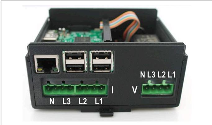
Figure 2. Le brochage des connecteurs de tension et de courant.
