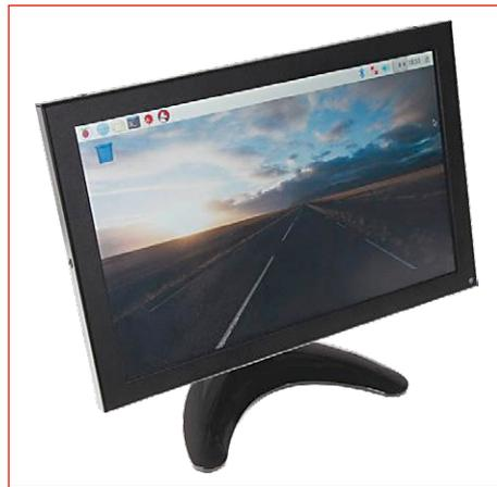
Écran tactile de 25 cm (10 pouces), logé dans un élégant et robuste boîtier métallique avec finition noire mate et dalle à vitre durcie (3H). Au dos de l'écran, une plaque peut recevoir n'importe lequel des ordinateurs monocartes courants (Raspberry Pi, etc). Alimentation par USB ou adaptateur secteur (fourni). Cet écran sert de moniteur de PC standard, grâce à ses connecteurs HDMI et VGA. Le compagnon idéal du microscope HDMI Andonstar ADMS201.
