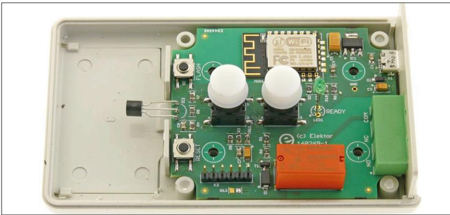
Figure 2. Le circuit imprimé a été conçu pour être facile à monter dans un boîtier bon marché.
