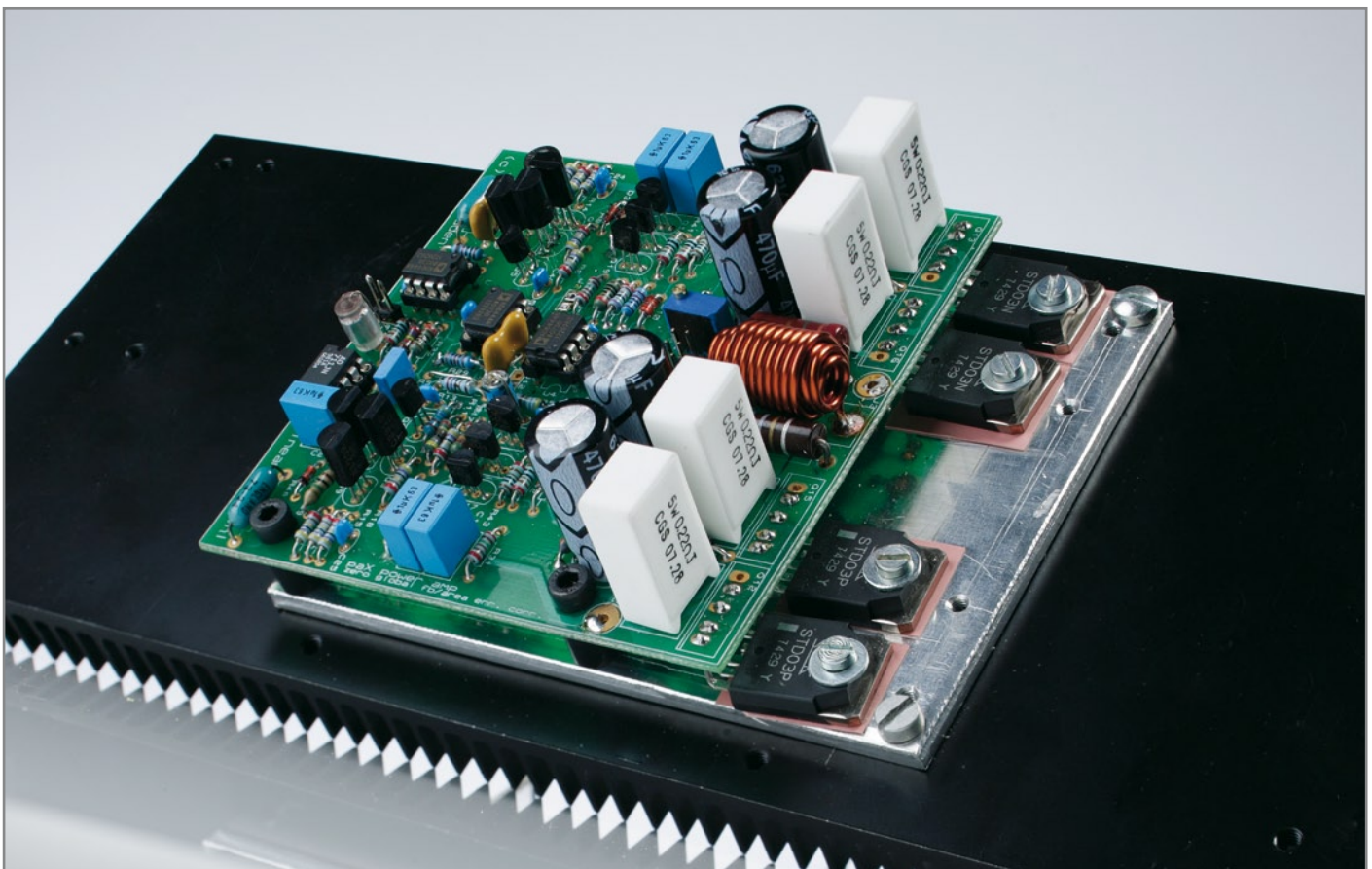
Figuur 10. De opgebouwde versterker-module op z'n koellichaam.
