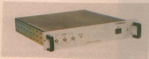
■ Thomson LGT-Thomcast : émetteur-pilote FM avec, au-dessus, son codeur -modulateur synchrone.
