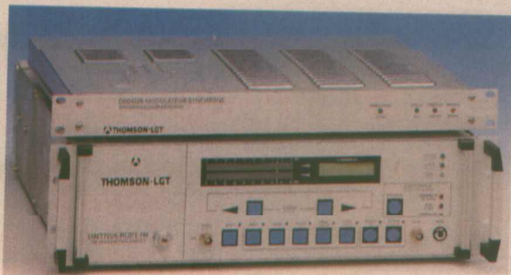
■ Thomson LGT-Thomcast : émetteur-pilote FM avec, au-dessus, son codeur -modulateur synchrone.
