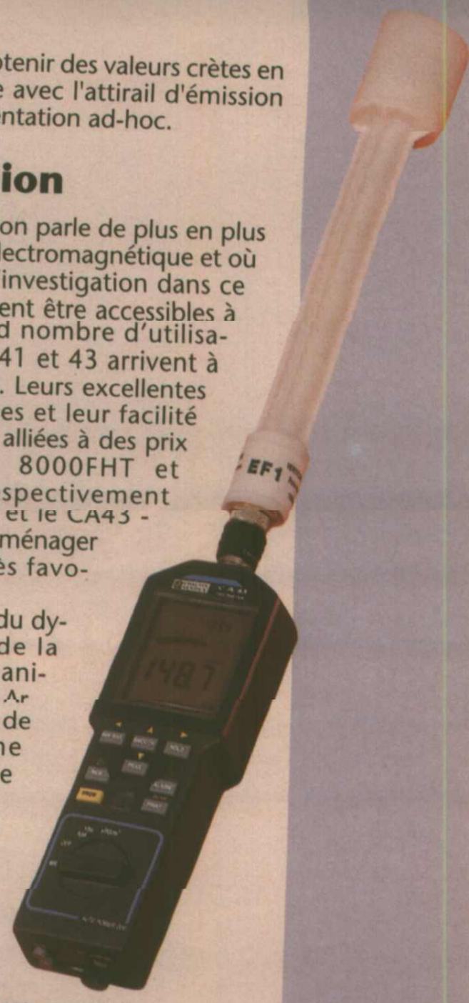
L'appareil (CA 43) raccordé à sa sonde ; on distingue en bas le potentiomètre de volume (mode modulateur en PEAK) et le connecteur optique RS232.
