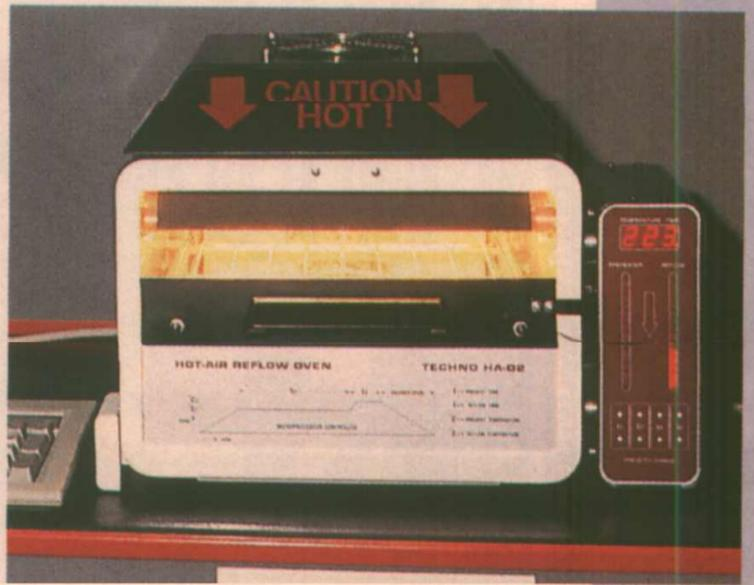
Le four en cycle de refusion. Les trois tubes à quartz 250W sont en action.
