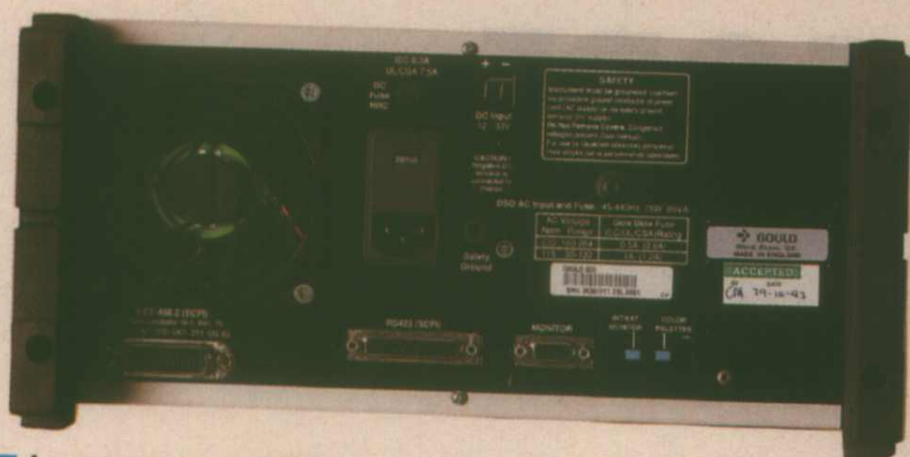
Le panneau arrière avec les connecteurs d'interface, l'entrée secteur et source d'énergie continue (fusible externe), et enfin les deux poussoirs de choix de palettes de couleur et d'activation d'un moniteur externe.
