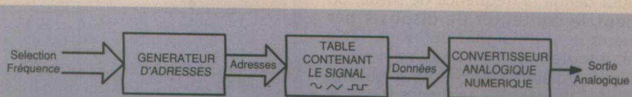
■ Figure 1 : schéma général d'un générateur numérique de signal
