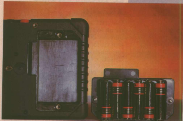
La trappe à piles extractible après le retrait de deux vis. L'accès à l'interface RS232 se situe à gauche et nécessite un adaptateur optionnel.
