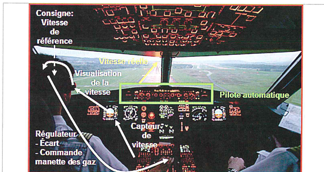
Fig. 2 Asservissement manuel de la vitesse et utilisation du pilote automatique de l'A320
