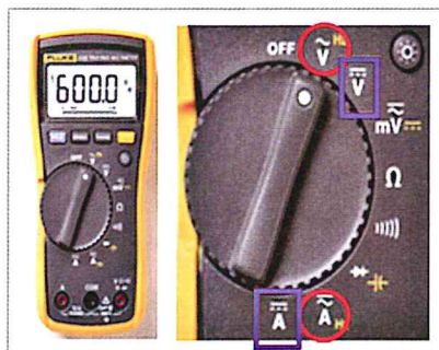
Fig. 9 Position DC (bleu) et AC (rouge) d'un multimètre
