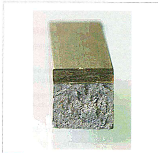
Fig. 6 Faciès de rupture ductile (cupules d'arrachement)
