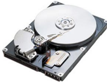
FIGURE 4.2 – L'intérieur d'un disque dur
