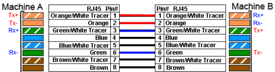
FIGURE 3.14 – RJ45 droit avec switch
