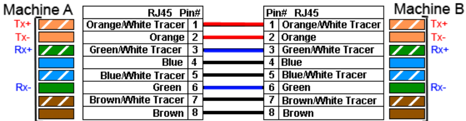
FIGURE 3.12 – RJ45 droit avec transmissions
