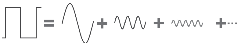
Figure 4.1 La décomposition d'un signal carré symétrique.
