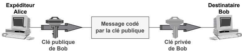
Figure 36.4 Principe de la cryptographie à clé publique.
