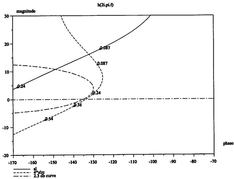
Par cette retouche on a pu ainsi augmenter le gain de la chaîne d'action, il est quatre fois plus important, tout en conservant une bonne marge de phase, de gain et un bon facteur de résonance.
