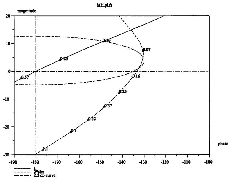
Avec ce réseau, le système n'a pas une marge très très importante, (bien que l'on ait multiplié le gain par deux), on va donc retoucher les deux fréquences,  $f_2$  et  $f_3$  : on prend  $f_2 = 0,09$  hertz : on remonte légèrement le point de pseudo pivotement, et on remonte plus fortement le point où l'avance de phase est maximale en prenant  $f_3 = 0,5$  hertz : on obtient ainsi le programme *Scilab* :
