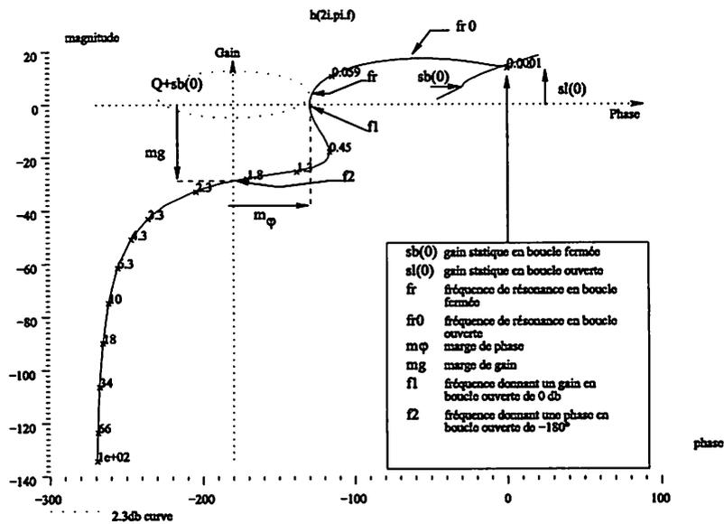
Si nous appelons  $sb(s)$ , dans l'exemple choisi, la transmittance de la boucle fermée,  $sl(s)$  étant le modèle de la boucle ouverte, la précision en régime statique vaut donc  $sl(0) / (1+sb(0))$ .
