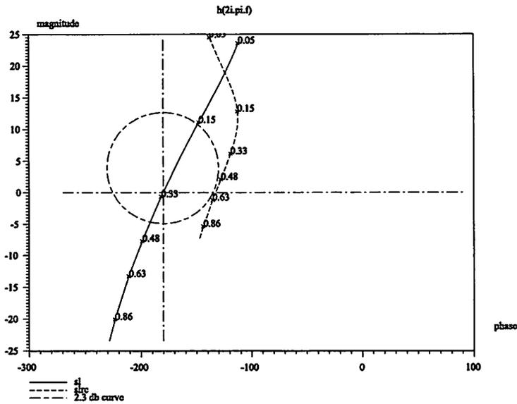
Nous voyons facilement qu'avec ce réseau, on a stabilisé le système (le facteur de résonance est maintenant très proche de 2,3db, en réalité 1,93db) et bien sur amélioré la précision : la boucle ouverte possède deux intégrateurs. On peut même, maintenant se permettre d'augmenter légèrement le gain de la chaîne d'action afin d'avoir un facteur de résonance de 2,3db.
