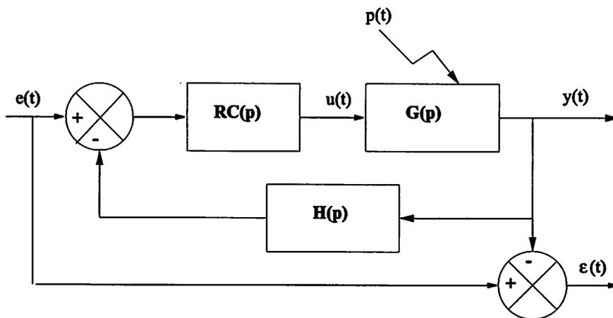
On voit apparaître sur ce schéma, l'erreur de l'asservissement, différence entre la consigne et la sortie. Dans la suite on définira la précision statique, étude de l'erreur en régime permanent, et la précision dynamique, caractérisant cette erreur au cours du temps.
