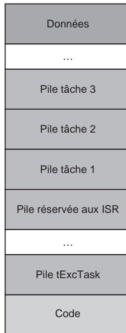
Figure 5.39 – Modèle de gestion mémoire (les positions relatives sont données à titre purement indicatif).
