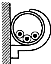
Conduit fixé directement aux parois par colliers, attaches
