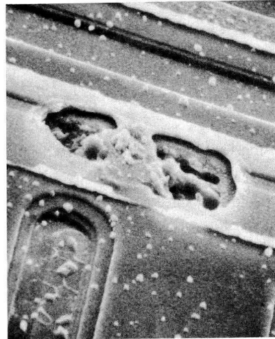
Figure 76 - Vue au microscope électronique à balayage d'un MOSFET de 6 A détruit par l'application à la grille d'une charge de 1 kV sur un « modèle du corps humain » (1,5 k \Omega en série avec 100 pF) (Document Motorola).
