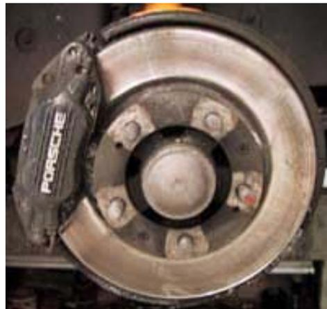
Figure 89b – Frein à disque pour automobile
