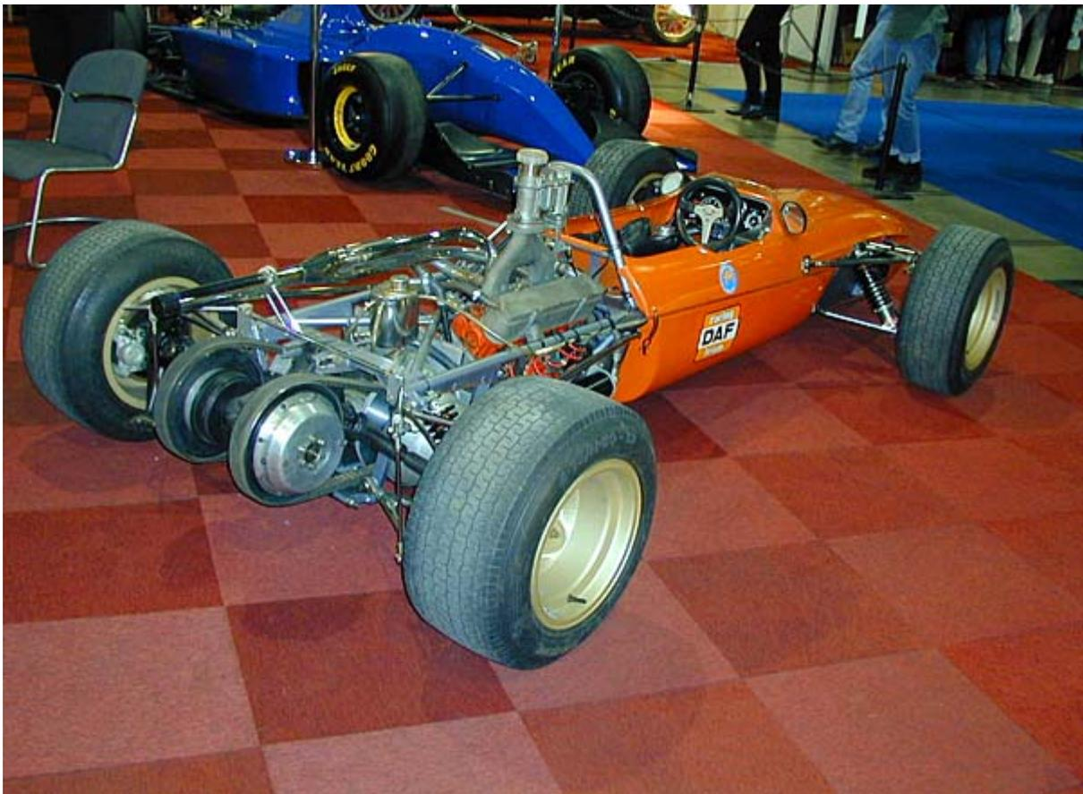
*Figure 32 - Transmission Variomatic sur véhicule de compétition DAF, formule F3, 1968*
