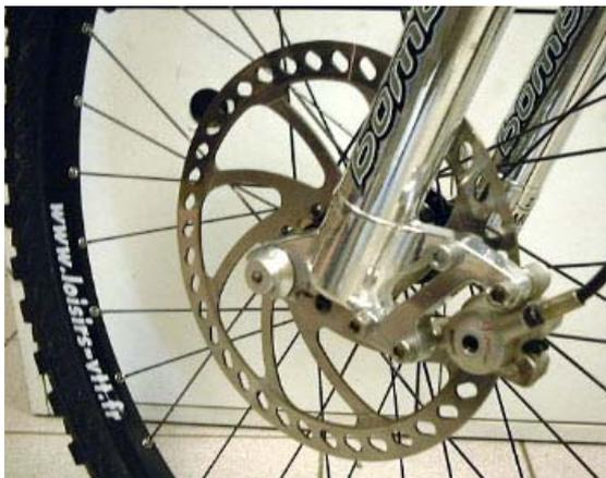
Figure 89a - Frein à disque pour VTT
