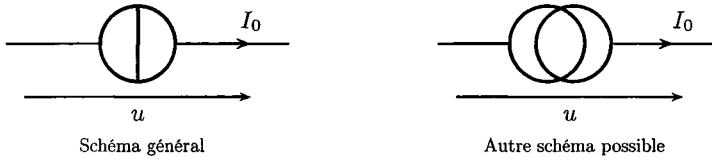
FIG. 5.17. Représentation d'une source idéale de courant.
