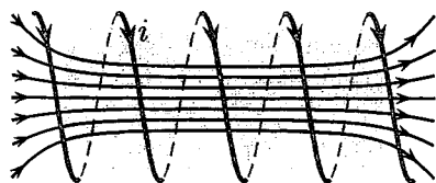
FIG. 20.5. Spectre magnétique d'un solénoïde. À l'intérieur du solénoïde, les lignes de champ magnétique sont quasiment parallèles à l'axe du solénoïde.
