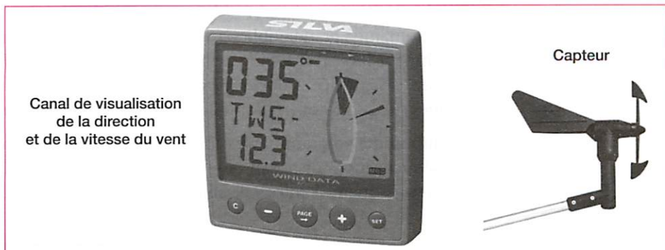
Figure 1.6 Capteur de vitesse et direction du vent et console de visualisation des informations captées
