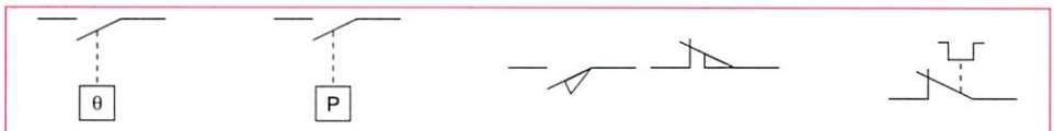
Figure F 3.4 Capteur de température-Capteur de pression-Capteurs de position-Contact de relais thermique
