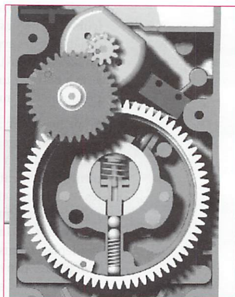
Figure 10.9 Mécanisme en position finale
