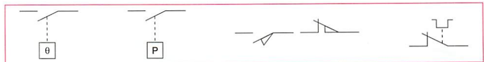
Figure F 6.4 Capteur de température-Capteur de pression-Capteurs de position-Contact de relais thermique
