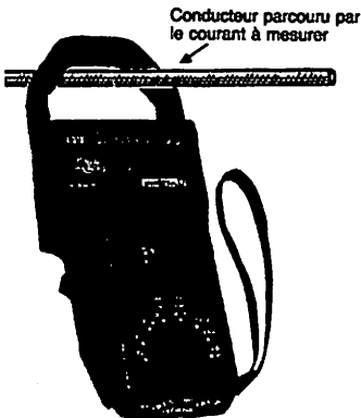
Fig. 6. Pince ampèremétrique. Le rapport de transformation I_1/I_2 est un nombre entier. La mesure de la valeur efficace I_2 permet la détermination rapide de l'intensité efficace I_1 .
