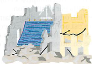
Les effondrements à plat (type mille-feuilles)
