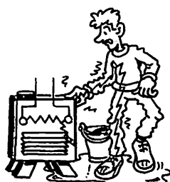
Fig. 3 : Contact indirect, masse mise accidentellement sous tension.
