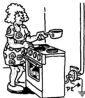
Fig. 16 : Toute masse reliée au conducteur de protection, lui-même relié à la terre.
